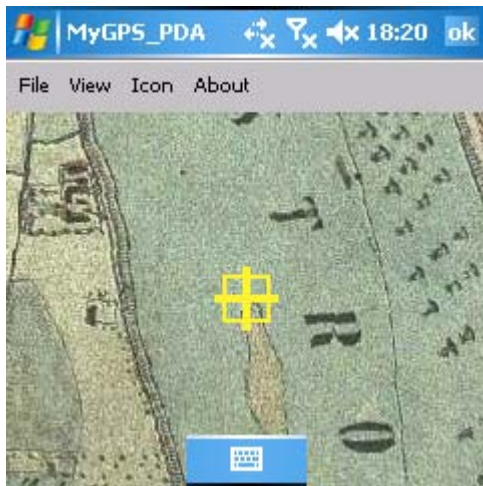
15. ábra. Kitűzési feladat: keressük meg a kis sziget helyét! Addig mozgunk a terepen, míg a szátkereszt a kívánt helyre nem kerül, és épp a sziget csúcsánál állunk. A terepen ma már semmi nem mutatja a régi tájat, a sziget (vonallal jelölve) a BME I épületétől keletre húzódott.
