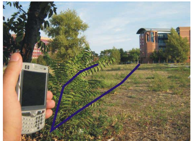
15. ábra. Kitűzési feladat: keressük meg a kis sziget helyét! Addig mozgunk a terepen, míg a szátkereszt a kívánt helyre nem kerül, és épp a sziget csúcsánál állunk. A terepen ma már semmi nem mutatja a régi tájat, a sziget (vonallal jelölve) a BME I épületétől keletre húzódott.
