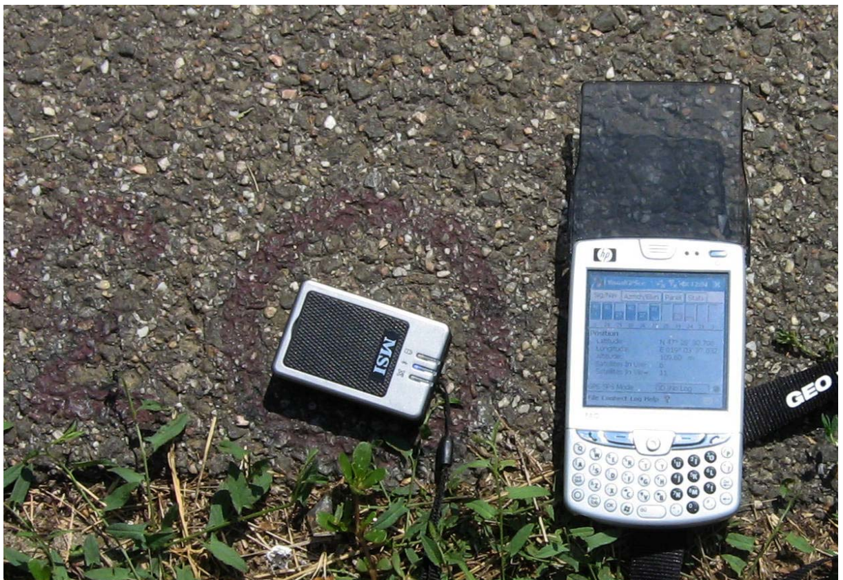
1. ábra. HP iPAQ 6915hw PDA (jobbra) és MSI SF200 Bluetooth GPS (balra) az ELTE 3. sz. alappontján. A PDA képernyőjén a VisualGPSce ingyenes szoftver futási képernyője látszik.
